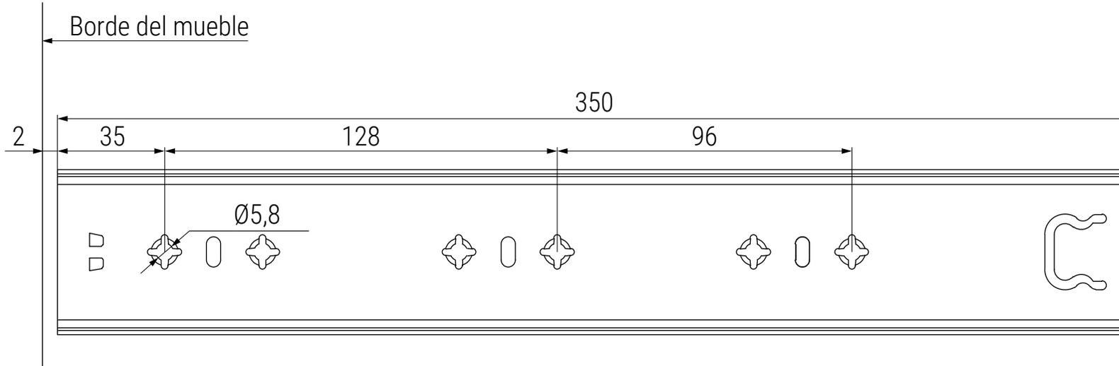
**Mecanizado de la Guía frente embutido**
